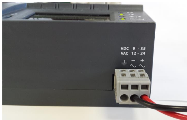
Figure 4 Branchement du connecteur d'alimentation arrière
