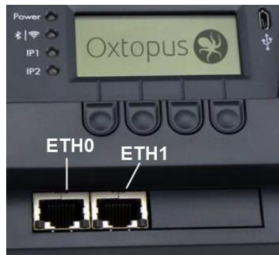
Figure 2 Connecteurs Ethernet Eth0 et Eth1
