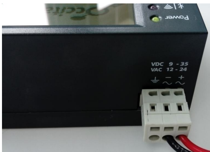
Figure 2 Branchement du connecteur d'alimentation arrière
