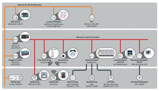
Le système d'automatisation de locaux e.control permet une communication BACnet IP de bout en bout.
